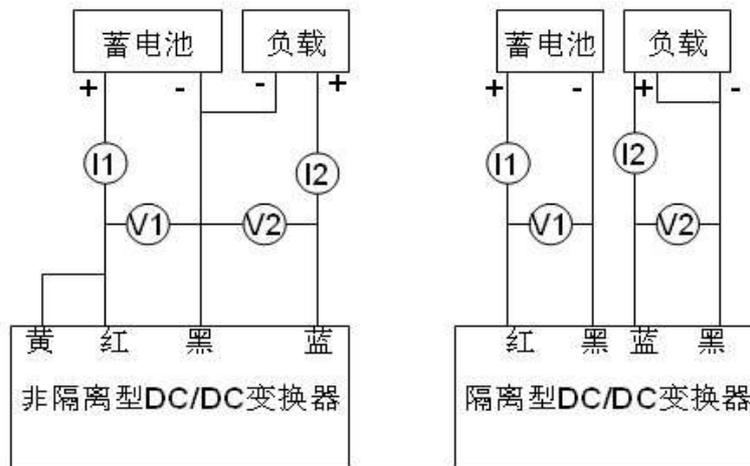
图2 测量转换效率接线图
